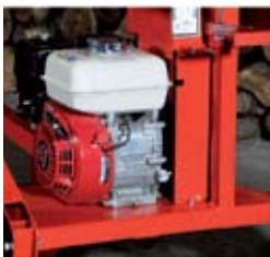
ÉQUIPÉ D'UN MOTEUR HONDA 5.5 CV.
